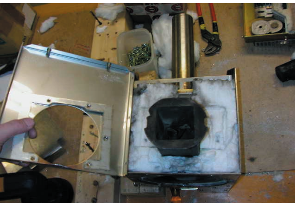
I exemplet ovan har i demonterat brännarröret vilket inte alltid är nödvändigt.
