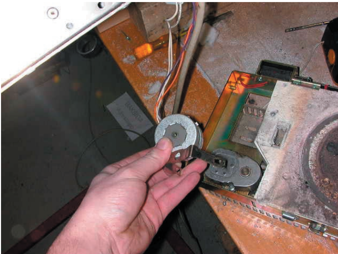
Lossa rotormotorn från växellådan genom att lossa bygeln
